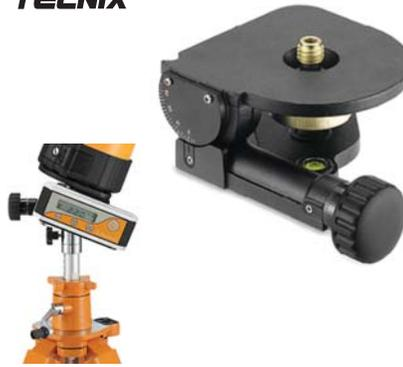
Questo piccolo e pratico accessorio è necessario per realizzare pendenze comprese tra 0° e 90° con tutti i livelli laser che possono operare in modalità "manuale", quindi col compensatore ed allarme di fuori bolla disattivati.
