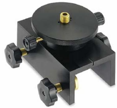
Questo piccolo e pratico accessorio è necessario per fissare tutti gli strumenti aventi attacco inferiore filettato standard 5/8" a strutture fisse, ove non fosse possibile posizionare un treppiede o fissare altrimenti lo strumento. La generosa larghezza dell'attacco inferiore permette di posizionare questo supporto su oggetti con misura massima 60mm. Ideale per fissare livelli laser, ottici, tacheometri, etc, su impalcature, ponteggi, tubi a sezione rettangolare, travetti, plinti, etc.
