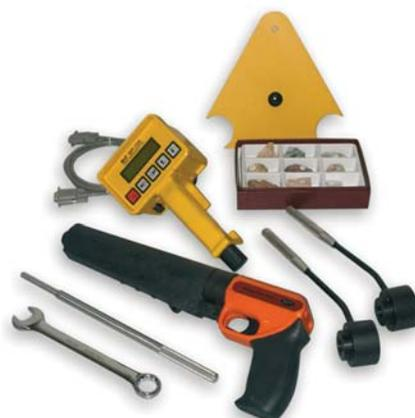
Il sistema Windsor HP Probe™ è stato progettato per valutare la resistenza a compressione del calcestruzzo in situ. Si tratta di un metodo non distruttivo e può essere utilizzato con uguale efficacia sul calcestruzzo fresco e maturo. Risultati altrettanto accurati sono ottenibili su superfici orizzontali o verticali a condizione che la sonda sia perpendicolare alla superficie di prova.
