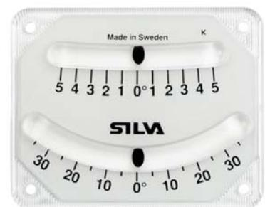
Clinometro meccanico a gravità, realizzato in ABS, provvisto di due scale di lettura, una con risoluzione 5° ed una seconda con risoluzione di 1° per una lettura sempre precisa dell'inclinazione.
