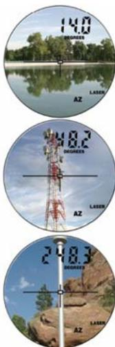
Determina distanze, altezze ed orientamento attraverso l'integrazione di un distanziometro a tecnologia laser, un clinometro elettronico ed una bussola.
