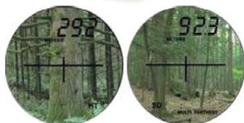
Il telemetro laser è uno strumento a cannocchiale in grado di misurare una distanza tra l'osservatore ed un oggetto. Sfrutta l'emissione di un raggio laser di bassa potenza e quindi non è pericoloso per gli occhi.
