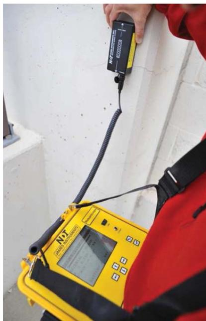
Il Rebarscope® è un pacometro rebar locator professionale che permette di individuare barre di rinforzo, cavi di tensione, trecce di rame, conduttori ecc... inoltre determina la profondità delle armature e la dimensione del tendino.
