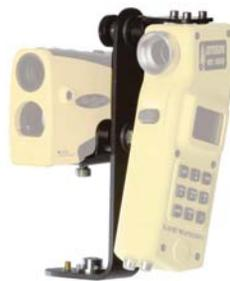
Il primo relascope/dendrometro elettronico, RD 1000 è in grado di misurare esattamente i diametri dell'albero lungo tutta la lunghezza del fusto.
