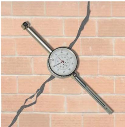
Questo strumento è adatto al controllo e alla misure di crepe e fessure che interessino strutture murarie e pavimenti. Alle estremità della crepa vengono fissate o cementate due piastrine forate in alluminio.
