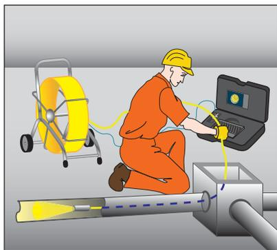
TECNIX VIDEOTRE è uno strumento particolarmente indicato per la videoispezione di tubature, pozzi, canali di scarico, controsoffitti e altre zone di difficile accesso.
