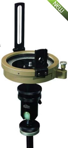
Tipo Schalkalder, bussola prismatica con sistema di collimazione a traguardo incernierato e regolabile per rilievi topografici, diametro del cerchio orizzontale 80 mm.
