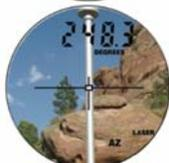
Determina distanze, altezze ed orientamento attraverso l'integrazione di un distanziometro a tecnologia laser, un clinometro elettronico ed una bussola.
