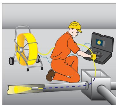
TECNIX VIDEOSETTE è uno strumento particolarmente indicato per la videoispezione di tubature, pozzi, canali di scarico, controsoffitti e altre zone di difficile accesso.
