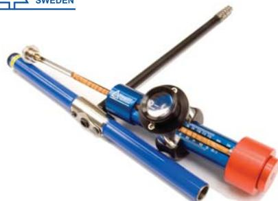
Strumento per l'analisi della carota estratta con il succhiello di Pressler. Inserendo direttamente l'estrattore con la carota al suo interno sarà possibile osservare il campione attraverso la lente di ingrandimento a 6X potendo inoltre effettuare misure grazie alle scale graduate sia in millimetri che in pollici presenti sullo strumento.
