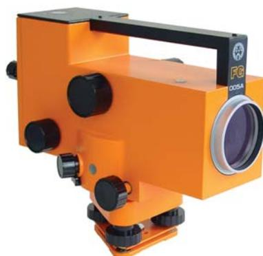
L'autolivello FG-005 è costruito con materiali e ottiche di elevata qualità. E' un livello di elevatissima precisione. Costruito per livellazioni geodetiche di 1° ordine, è dotato di un micrometro a lamina pianparallela con lettura diretta nell'oculare dello strumento, grazie al quale è possibile raggiungere la ragguardevole precisione di ± 0,5mm/Km. E' adatto a tutti gli impieghi nel campo dell'ingegneria, dell'industria e delle livellazioni di precisione.
