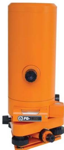
Piombo ottico zenitale di elevata precisione completamente autolivellante. Dotato di basetta con piombo ottico nadirale.
