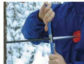
Strumento pieghevole utile per facilitare l'inserimento del succhiello di Pressler nella corteccia anche in presenza di lastre di ghiaccio. BORER STARTER aiuta l'operatore nella estrazione più precisa dei campioni di legno.
