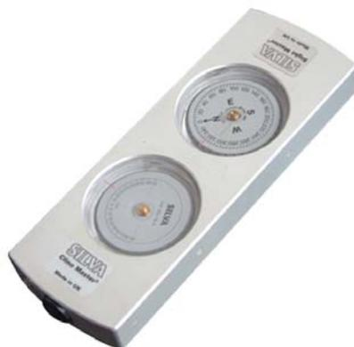
Silva SurveyMaster SUR-360-LA, strumento brevettato, è una combinazione di SightMaster e ClinoMaster, particolarmente adatto per i professionisti che hanno bisogno di misurare gli angoli verticali, altezze e orientamenti.
