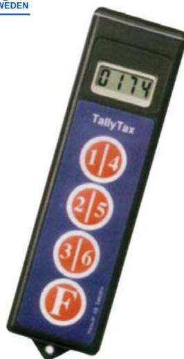
Contatutto elettronico Haglöf Tallytax. E' in grado di contare fino a 6 classi di oggetti diversi, mantenendo in memoria il valore di ogni singola classe. Premendo il tasto relativo alla classe selezionata, il relativo contatore progredisce di una unità. Molto utile in campo forestale e possibilità di suddividere gli alberi contati per specie.
