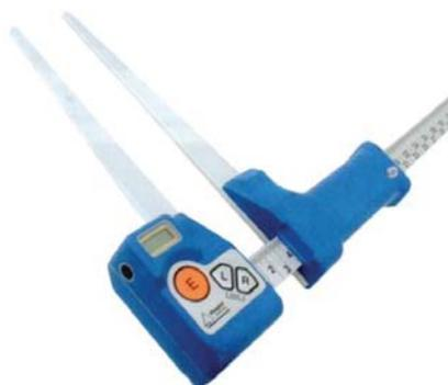
Il DIGITECH è in grado di immagazzinare migliaia di diametri ed altezze e di trasferirli successivamente ad un PC. Puoi trasferire i dati memorizzati anche in real time al tuo PocketPC o Laptop elaborandoli e gestendoli in ambiente Windows.
