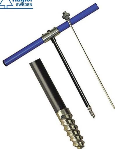
Detto anche Sonda incrementale. Viene utilizzato per prelevare campioni nei tronchi al fine di valutare età, crescita, salute dell'albero, influssi negativi da inquinamento, densità del legno. Viene fornito completo di impugnatura e trivella (a doppio filetto) in acciaio ad alta resistenza. Il preciso estrattore ha copertura in Teflon.
