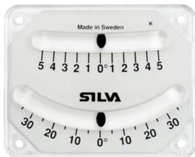
Clinometro meccanico a gravità, realizzato in ABS, provvisto di due scale di lettura, una con risoluzione 5° ed una seconda con risoluzione di 1° per una lettura sempre precisa dell'inclinazione. Il clinometro è applicabile su qualsiasi superficie verticale.
