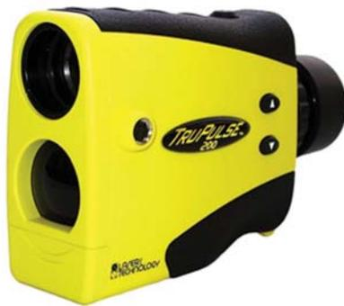
Determina distanze e altezze attraverso il distanziometro a tecnologia laser ed un clinometro elettronico integrato. La visualizzazione dei dati avviene all'interno dell'ottica su un display LCD senza spostare l'occhio utilizzato per la collimazione.
