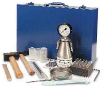
**Fornito con:** Custodia rigida, reagente, Sfere di acciaio, accessori d'uso, manuale in italiano.
