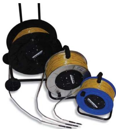
Freatimetro con cavo tondo (diam. 4.7 mm) a quattro conduttori, con anima in kevlar e guaina esterna di protezione, graduazione ogni centimetro (stampata sul cavo e protetta dalla guaina esterna in poliuretano antigraffio trasparente).
