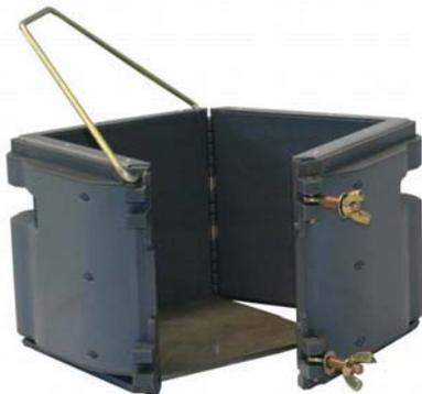
Stampo in ABS apribile con cerniere in acciaio per la realizzazione di campioni di calcestruzzo per esami da effettuarsi in laboratorio.
