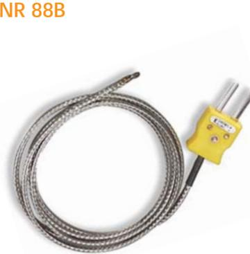
Sonda tipo K flessibile in acciaio.
