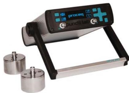
PUNDID PLUS è un'apparecchiatura ad ultrasuoni che può essere utilizzata per la determinazione non distruttiva della qualità del calcestruzzo.
