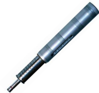
Piccolo strumento tascabile per la rapida determinazione della resistenza alla compressione semplice.
