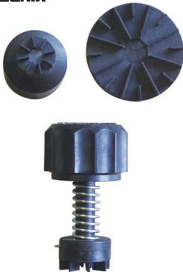
Scissometro manuale indicato per la determinazione della resistenza al taglio di terreni coesivi sia in situ che su campioni in laboratorio.
