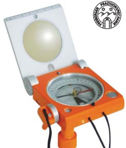
Specifica per rilievi di geologia strutturale, tettonica, ingegneria geologica, trova impiego anche in speleologia, topografia e in rilievi all'interno di cavità, gallerie e miniere.
