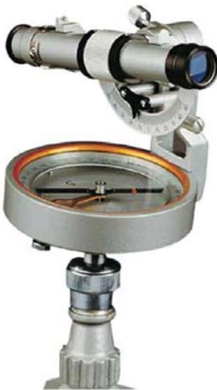
Bussola da rilievo tacheometrico, caratterizzata da un telescopio a 8x con cerchio graduato per letture di inclinazione.
