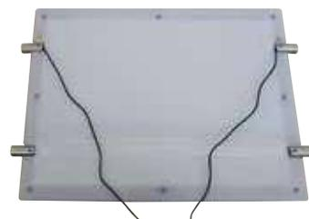
Sul retro di ogni cornice sono posti due adesivi con le polarità. Si smonta il distanziale metallico e si innesta il filo, assicurandosi che la polarità sia corretta. Si riavvita il tutto per consentire poi la diffusione dell'elettricità all'interno del bianario.
