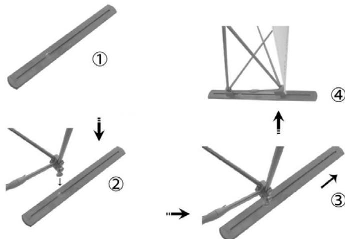
Inserire la vite posta sul fondo del POP-UP nel foro della base (2), spingere il POP-UP verso la parte posteriore della base dopo aver inserito la vite (3). Inserire la seconda vite nel foro e spingere il POP-UP verso la parte superiore (4).
